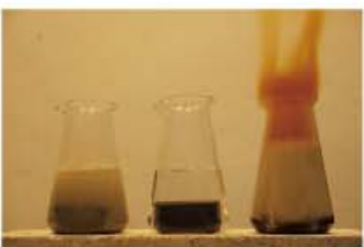
写真左側から コンクリート / RASHIX-HD / 鉄 耐酸試験の様子
