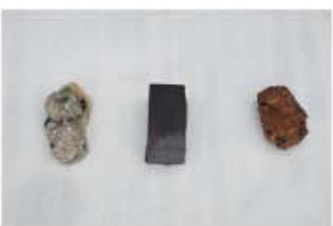
コンクリート / RASHIX-HD / 鉄 耐酸試験の結果
